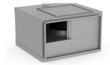
КОРПУС вентилятора выполнен из оцинкованной стали и обеспечивает надежную защиту от коррозии. На всех типоразмерах C-PKV-BC-S предусмотрена крышка для сервисного обслуживания рабочего колеса и двигателя при монтаже или обслуживании вентилятора.
